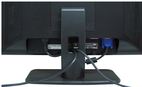
Dopo aver fissato tutti i cavi al monitor e al computer, (Si veda [Collegamento del Monitor](#) per i collegamenti dei cavi,) usare il passacavi per organizzare i cavi in maniera ordinata, come mostrato sopra.
